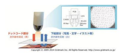
Gスキャナーは、見えないドットコードを読み取るための専用スキャナーです。 Gスキャナーの先端部には赤外線小型カメラが内蔵されており、カメラ内のLEDから照 射された赤外線の反射光を感知することで、ドットコードだけを読み取ります。
