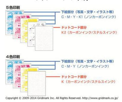
ドットコードを印刷するときは、ドットコード部分には赤外線吸収インク (カーボンイン ク/ステルスインク)、写真・文字などの下絵部分には赤外線非吸収インク (ノンカーボン インク)を使用します。
